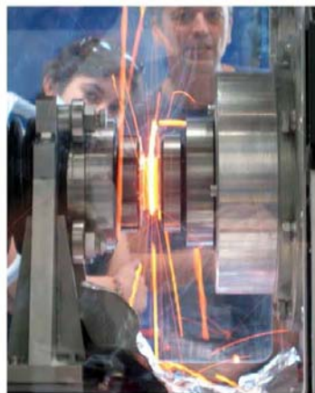
图 2-2 罗马国家地球物理和火山学研究所利用 SHIVA 从事高应变率的摩擦熔融实验
