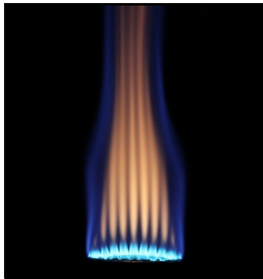
(d): Complete Sooting
