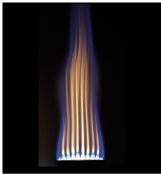
(d) Complete Sooting
