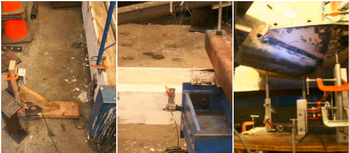
Figure 4.7 Potentiometers (a) Unimeasure P510 (b) BEI Duncan 9600 (c) BEI Duncan 600
