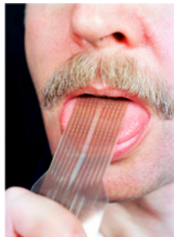
Fig. 16 - TDU, Tongue Display Unit
