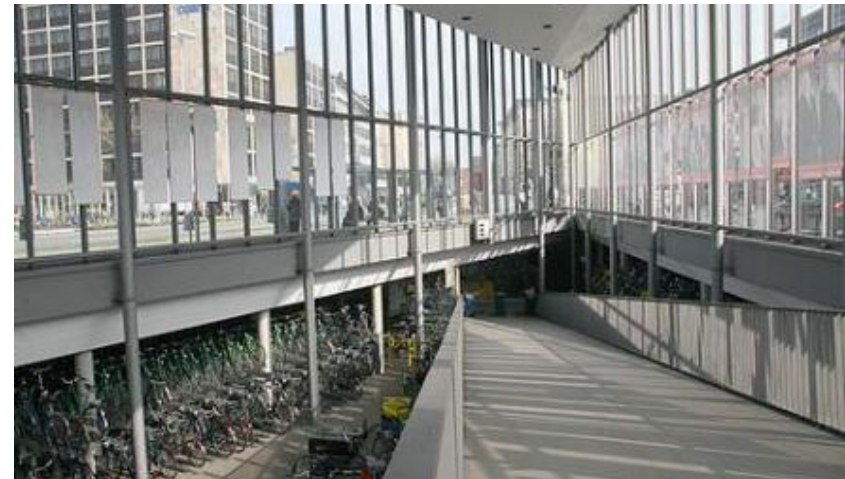
Figure 36 There is a gentle ramp down to the bike parking from the transit platform. Soucre: Bruni Frobusch, "Allen Unkenrufen zum Trotz: Radstation ist ein Erfolgsmodell," echo-muenster.de , July 2004, Web.
