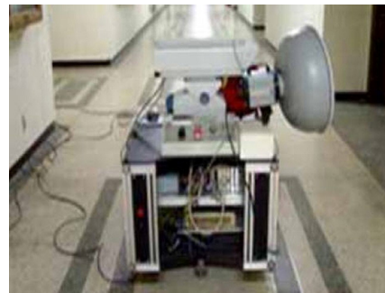
(d) Tunnel inspector by Yu et al
